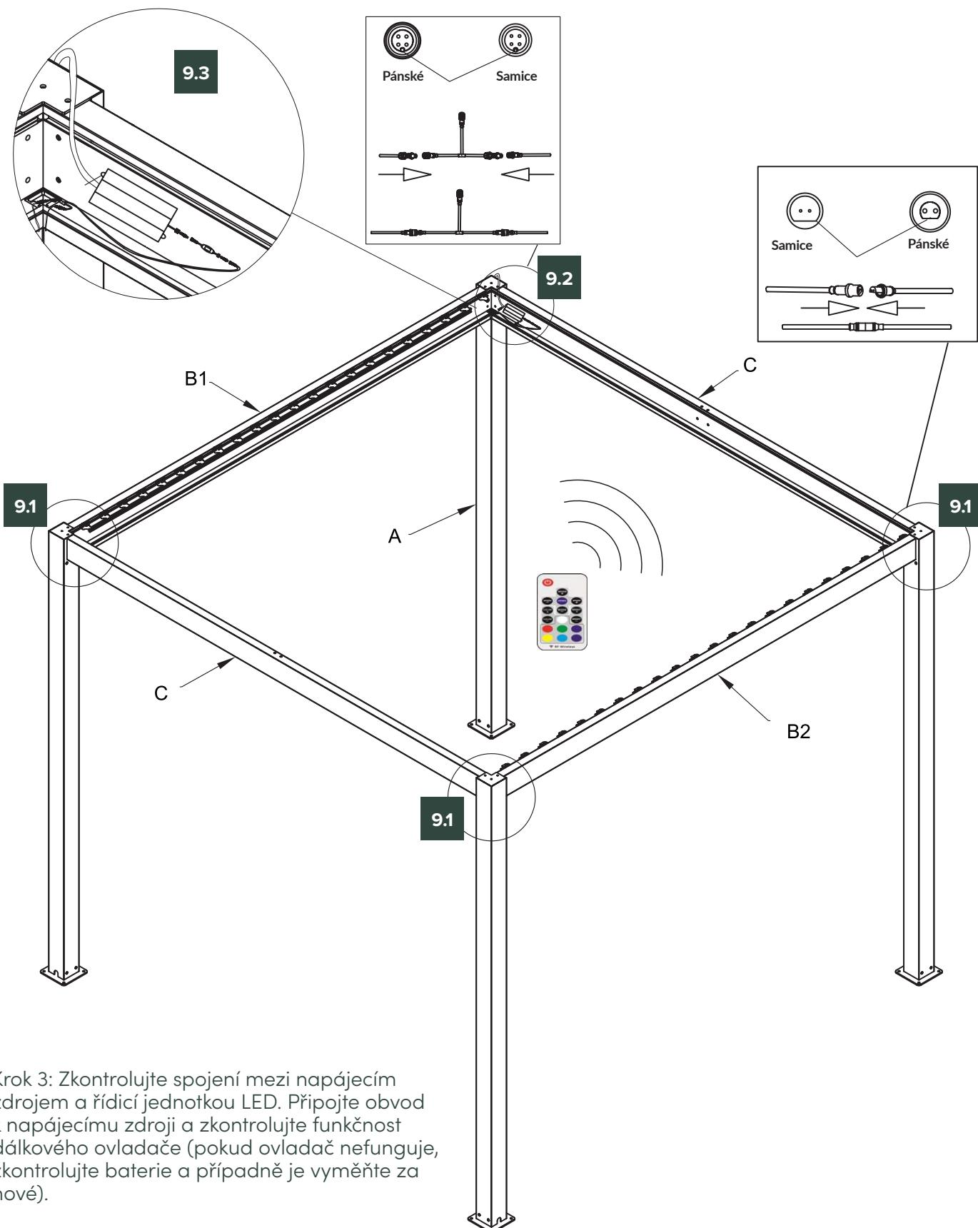
Krok 3: Zkontrolujte spojení mezi napájecím zdrojem a řídicí jednotkou LED. Připojte obvod k napájecímu zdroji a zkontrolujte funkčnost dálkového ovladače (pokud ovladač nefunguje, zkontrolujte baterie a případně je vyměňte za nové).
