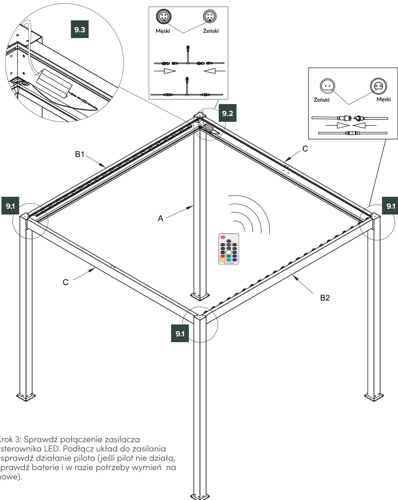
Krok 3: Sprawdź połączenie zasilacza i sterownika LED. Podłącz układ do zasilania i sprawdź działanie pilota (jeśli pilot nie działa, sprawdź baterie i w razie potrzeby wymień na nowe).
