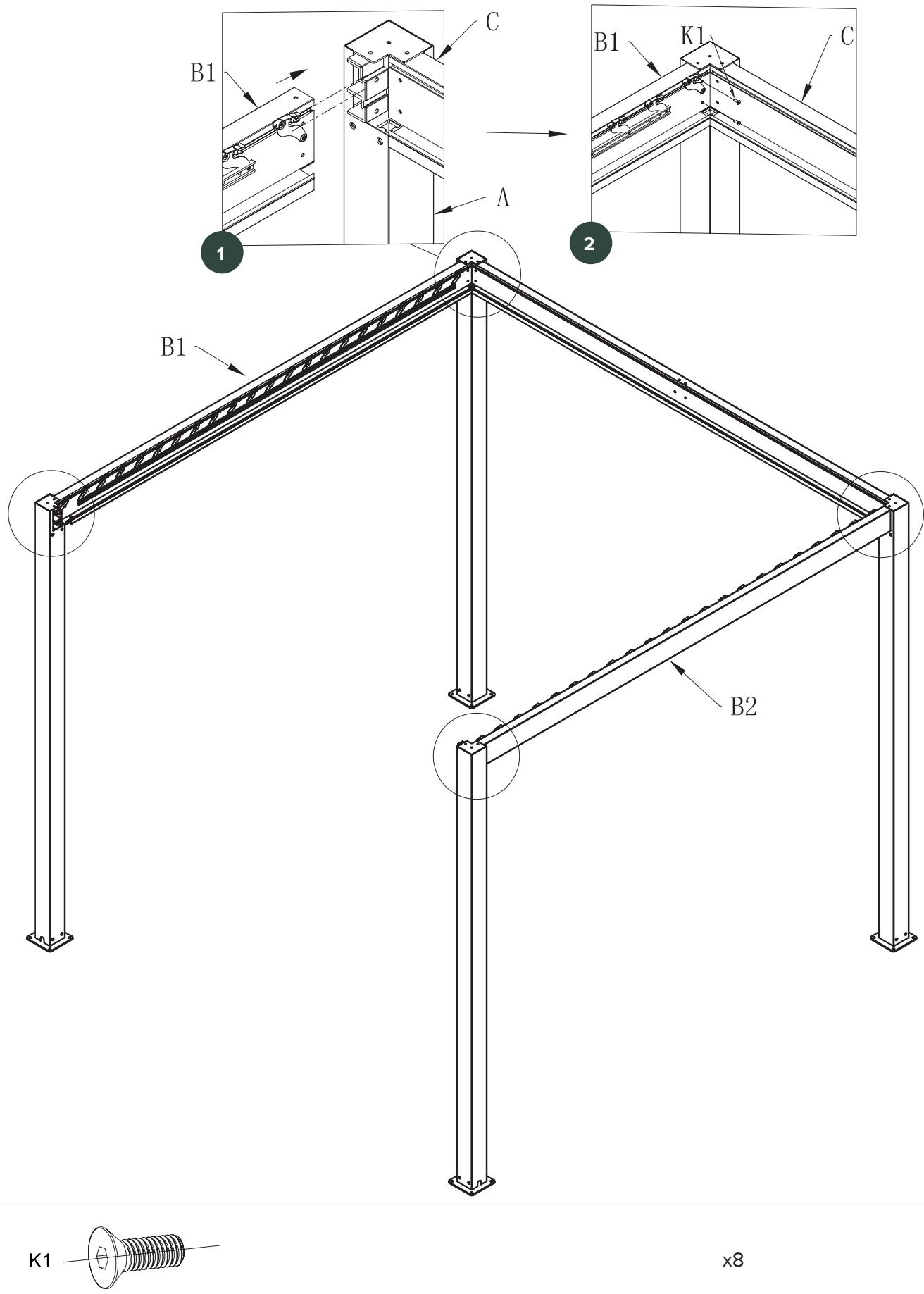
Włożyć końce pozostałych belek przednich i tylnych (C) do łączników narożnych na słupie i dokręć śrubami (K1).
