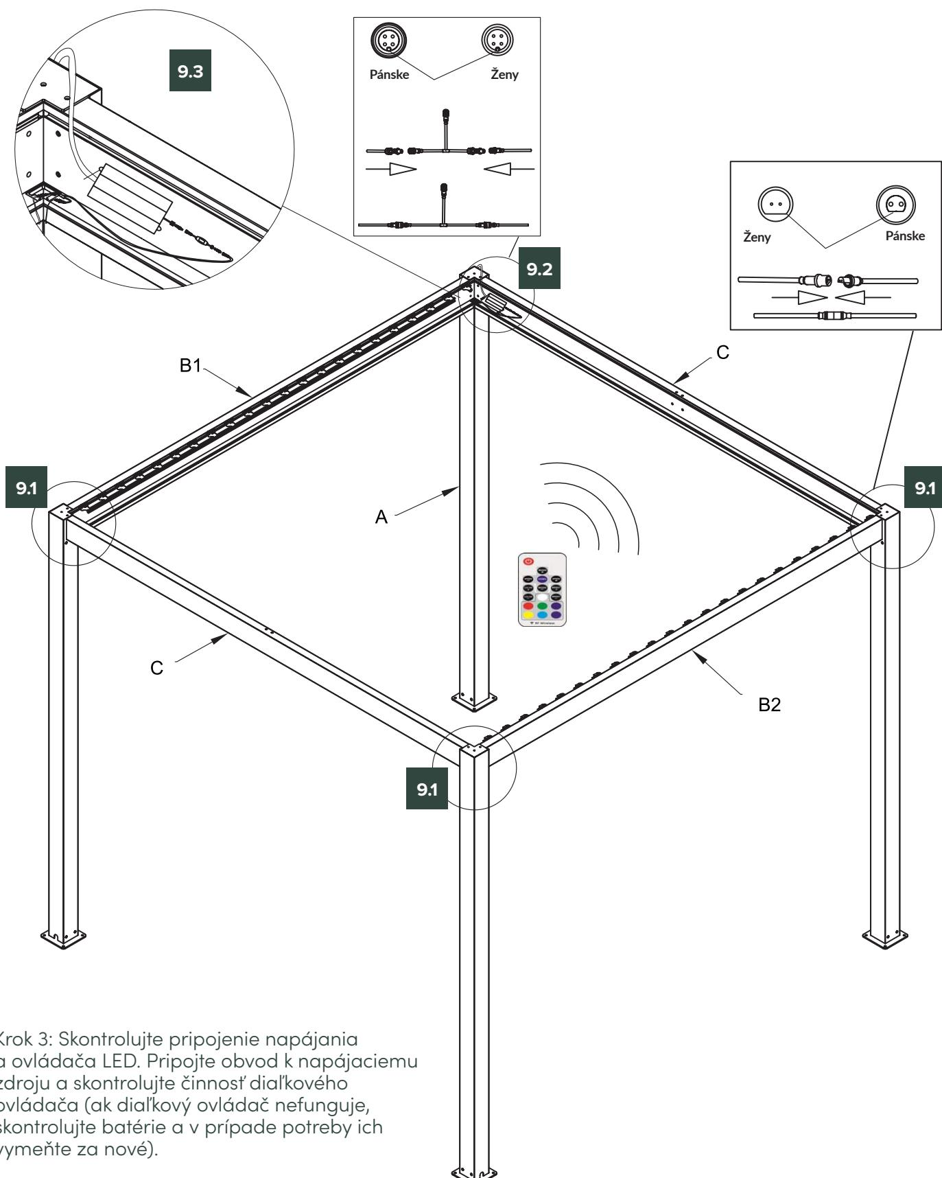
Krok 3: Skontrolujte pripojenie napájania a ovládača LED. Pripojte obvod k napájaciemu zdroju a skontrolujte činnosť diaľkového ovládača (ak diaľkový ovládač nefunguje, skontrolujte batérie a v prípade potreby ich vymeňte za nové).
