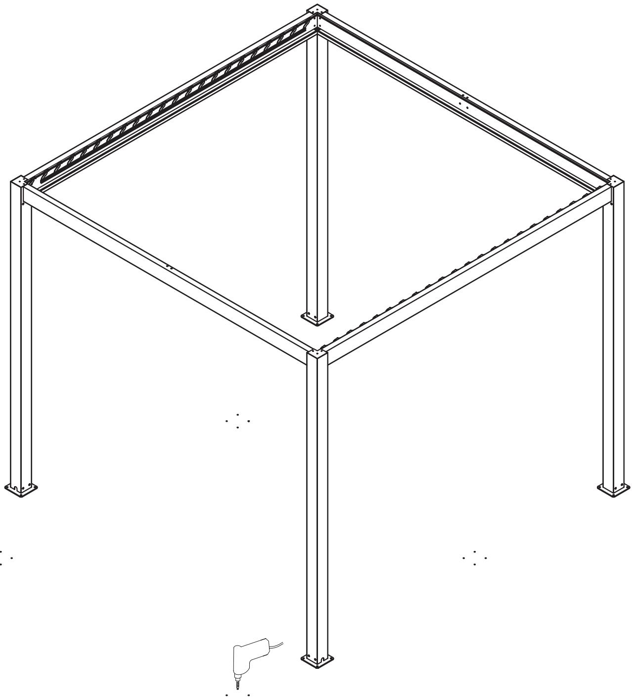
Umístěte hmoždinky (L) do vyvrstaných otvorů a poté posuňte výrobek zpět tak, aby otvory pro dlaždice byly v jedné linii s hmoždinkami. Poté pomocí šroubů a podložek (L) připevněte pergolu k zemi. Nezapomeňte všechny šrouby pevně utáhnout.
