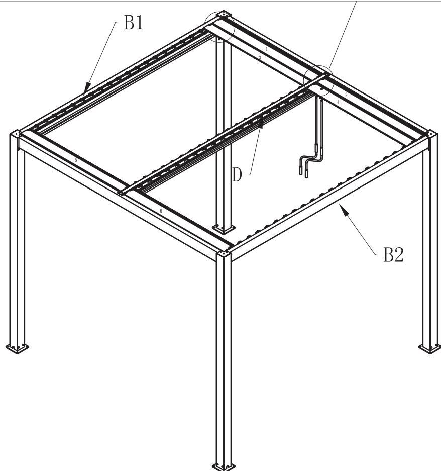
Zaskrutkujte skrutku (K2) s podložkou (K3) v súlade s otvorom pod tyčou (D), to isté zopakujte pre tyč (C). Vložte druhú tyč.
