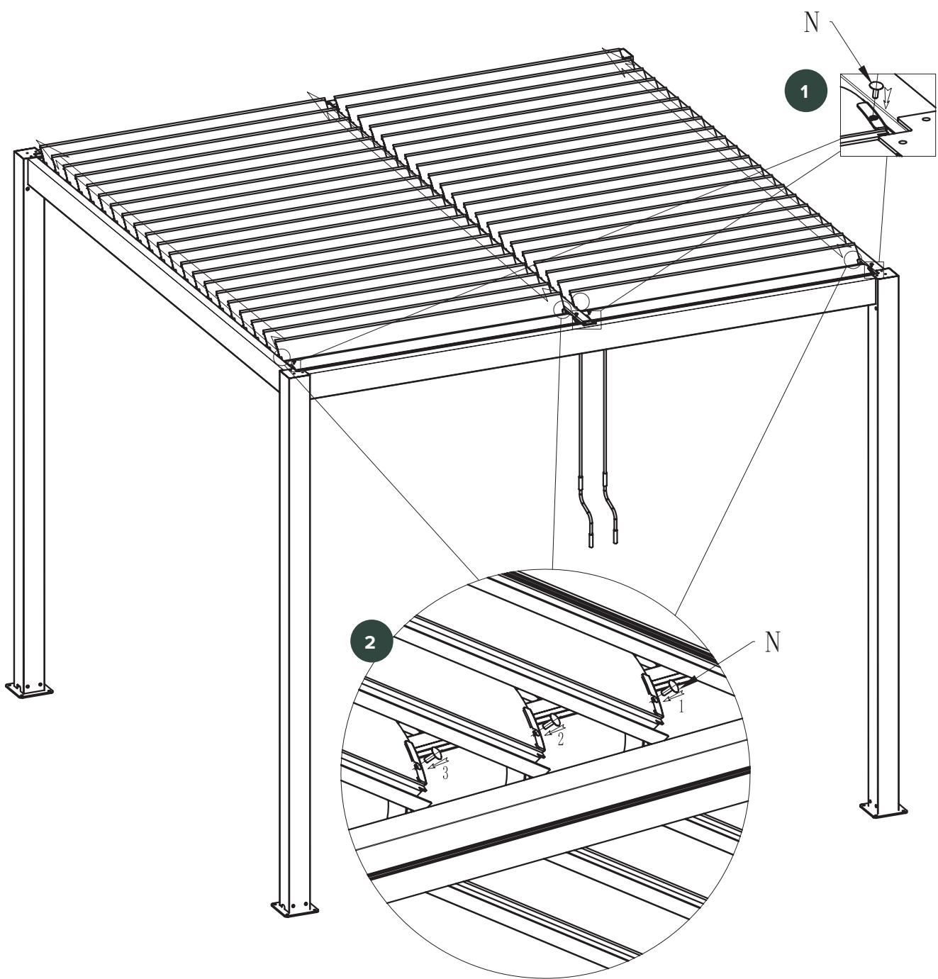
Otočte lamely do polovice, do otvoru na oboch koncoch každej lamely postupne zasuňte plastový kolík (N).
