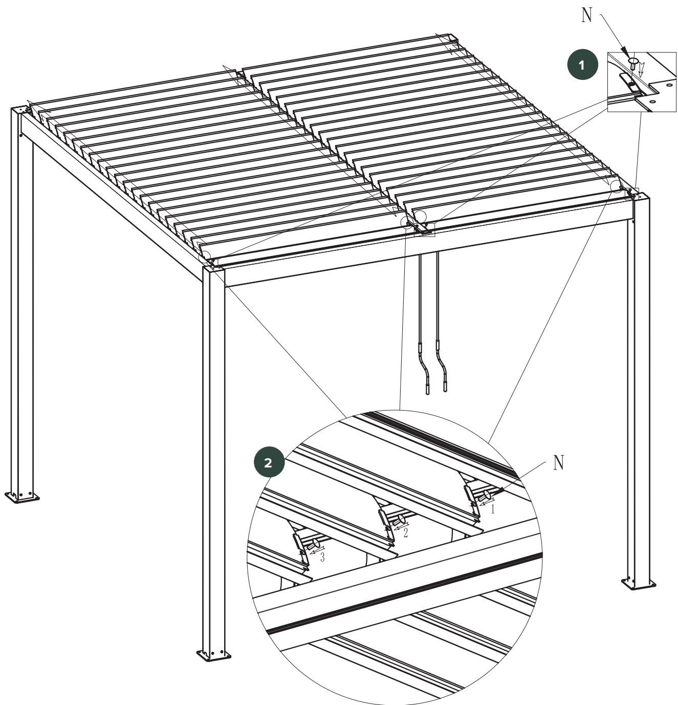
Lamely otočte do poloviny a do otvoru na obou koncích každé lamely postupně zasuňte plastový kolík (N).
