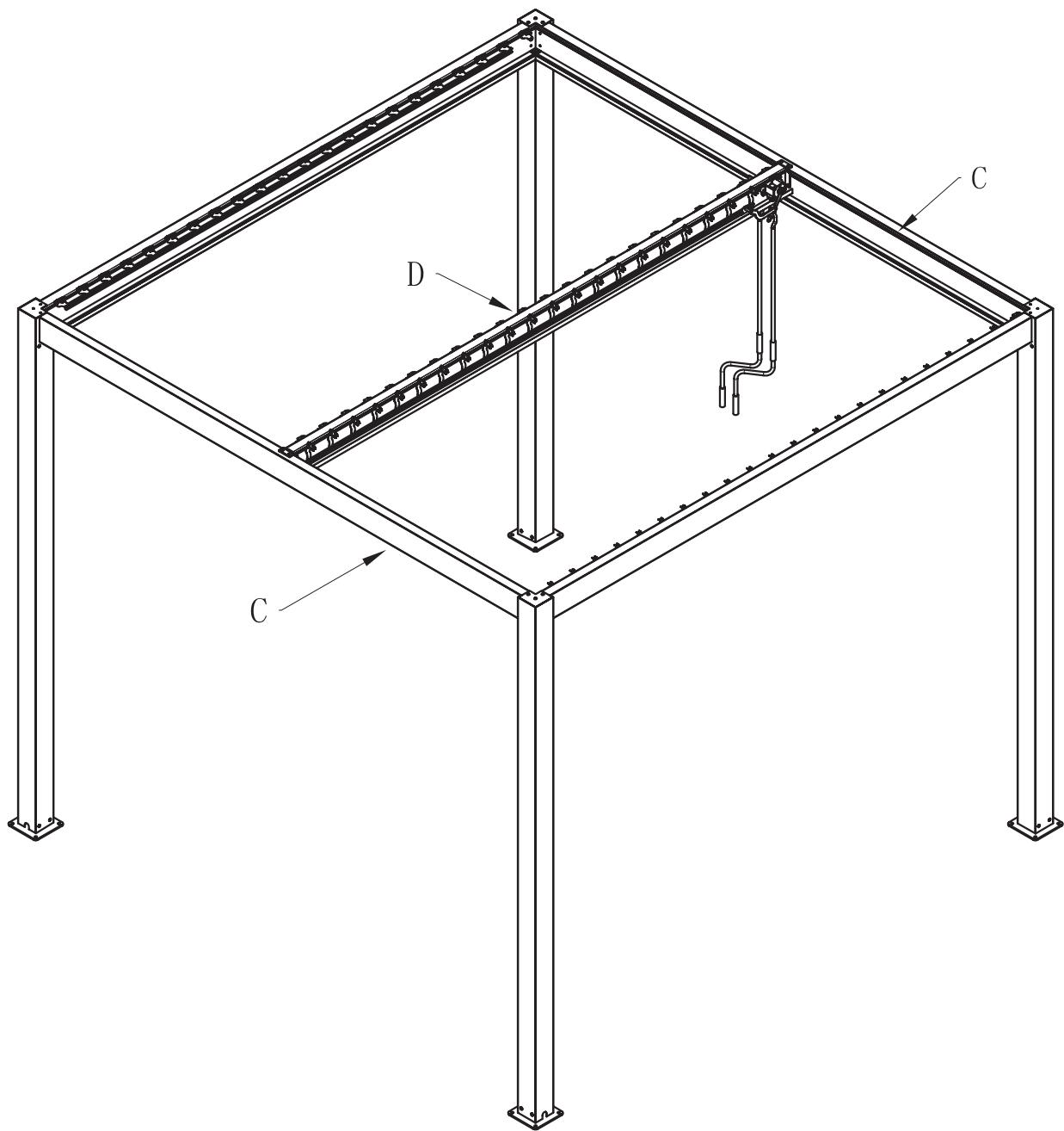
Na konce držáků na obou stranách nosníků (B1-D) vložte 6 kusů obložení (E) (4 kusy na straně převodovky a 2 kusy na druhé straně). Lišty utáhněte podle níže uvedeného náčrtu, aby byly zajištěny.
