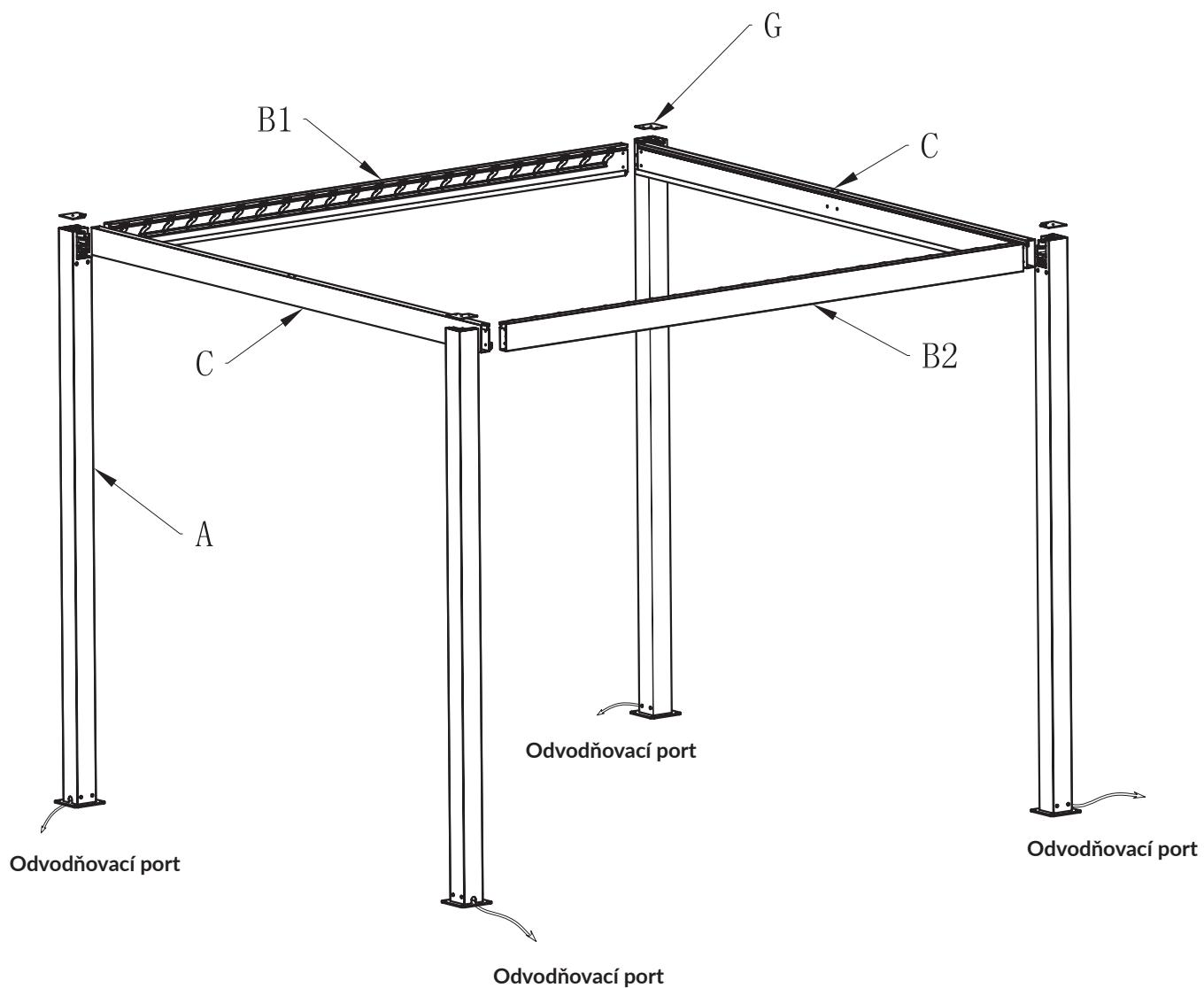
Uistite sa, že oba konca predného a zadného nosníka (C) sú správne umiestnené na rohových konektoroch na stípe a že skrutky K1 sú dotiahnuté.
