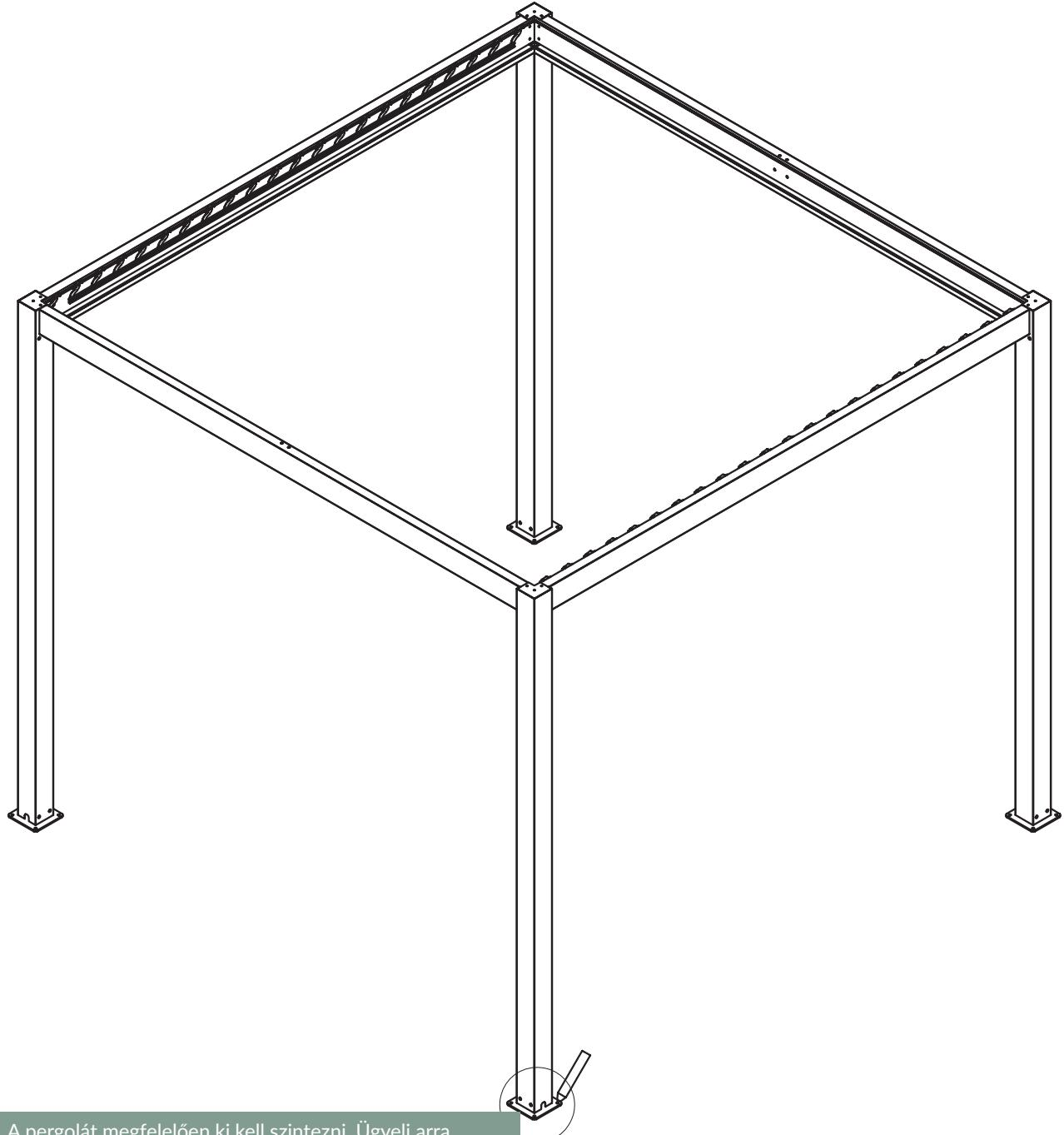
A pergolát megfelelően ki kell szintezni. Ügyelj arra, hogy a pergola négy oszlopának helyzete merőleges legyen a talajhoz. Csak ezután kezdjük el a talajhoz való rögzítést, majd az útmutatónak megfelelően szereljük fel a tetőelemeket és a napellenzőket. Merőleges legyen a talajhoz!
