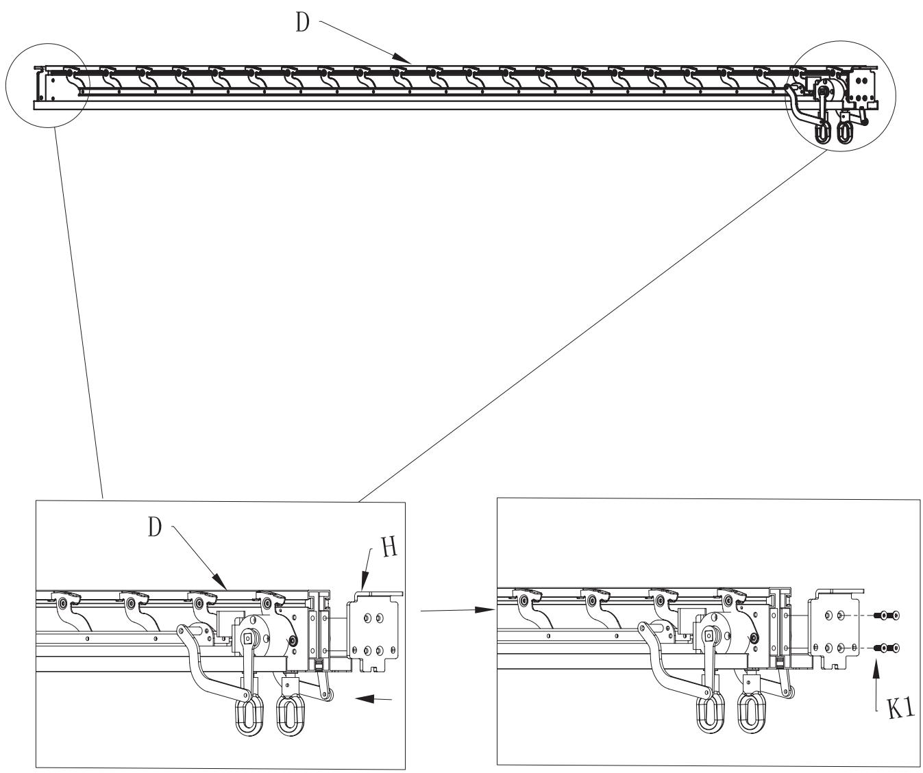
Vložte oba závěsné kroužky (!) do hnací hřídele převodovky na nosníku (D), zašroubujte a upevněte matici (K4).
