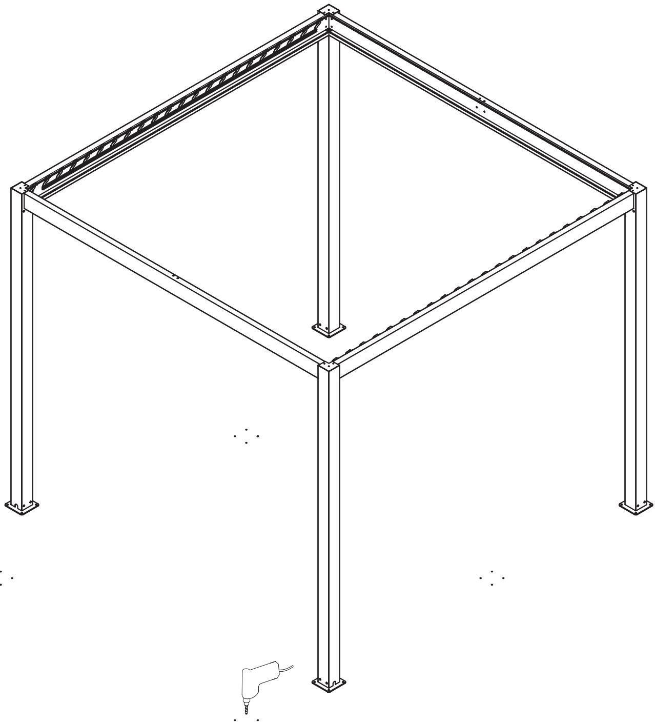
Helyezze a dübeleket (L) a kifúrt lyukakba, majd mozgassa vissza a terméket úgy, hogy a lap nyílásai igazodjanak a dübelekhez. Ezután csavarokkal és alátétekkel (L) rögzítse a pergolát a talajhoz. Ne felejtse el szorosan meghúzni az összes csavart.
