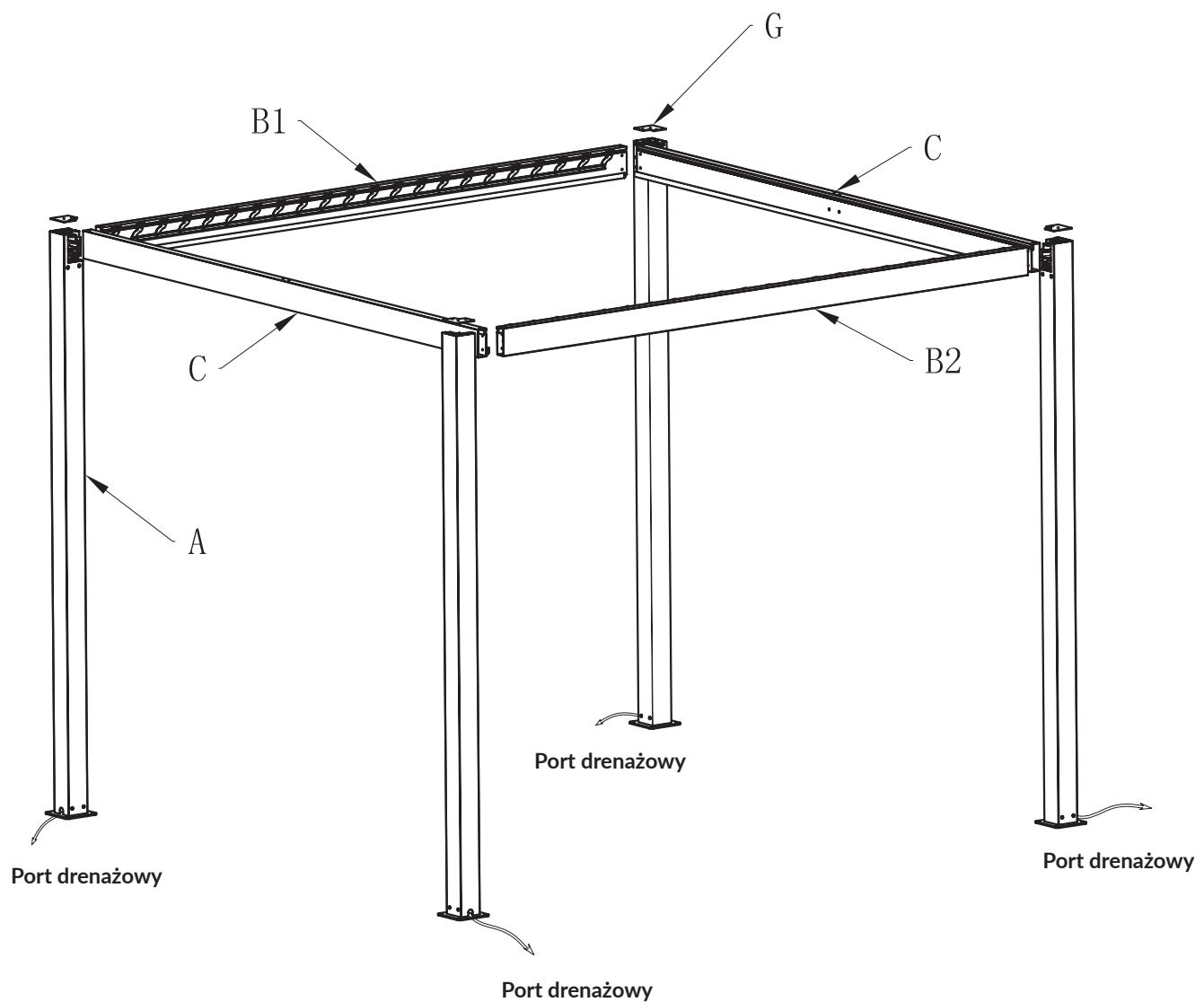
Upewnij się, że dwa końce przedniej i tylnej belki (C) są odpowiednio umieszczone na łącznikach narożnych na kolumnie, a śruby K1 są dokręcone.
