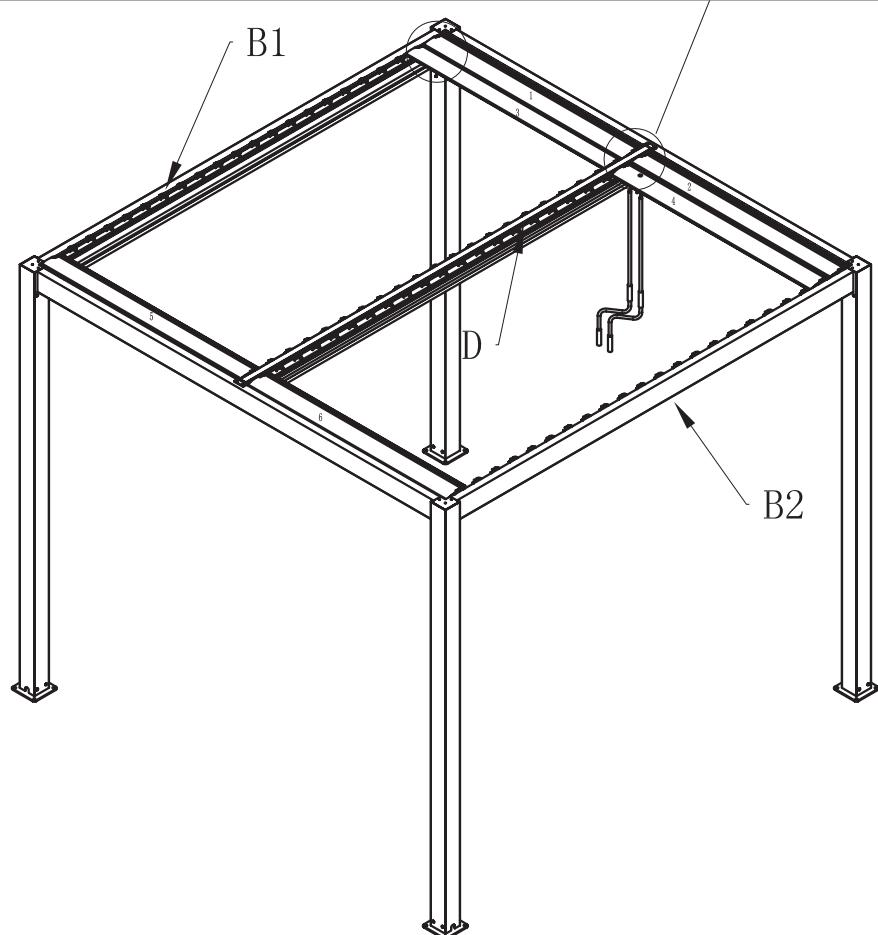
Šroub (K2) s podložkou (K3) zašroubuje do otvoru pod tyčí (D), totéž zopakujte pro tyčí (C). Vložte druhou tyčí.
