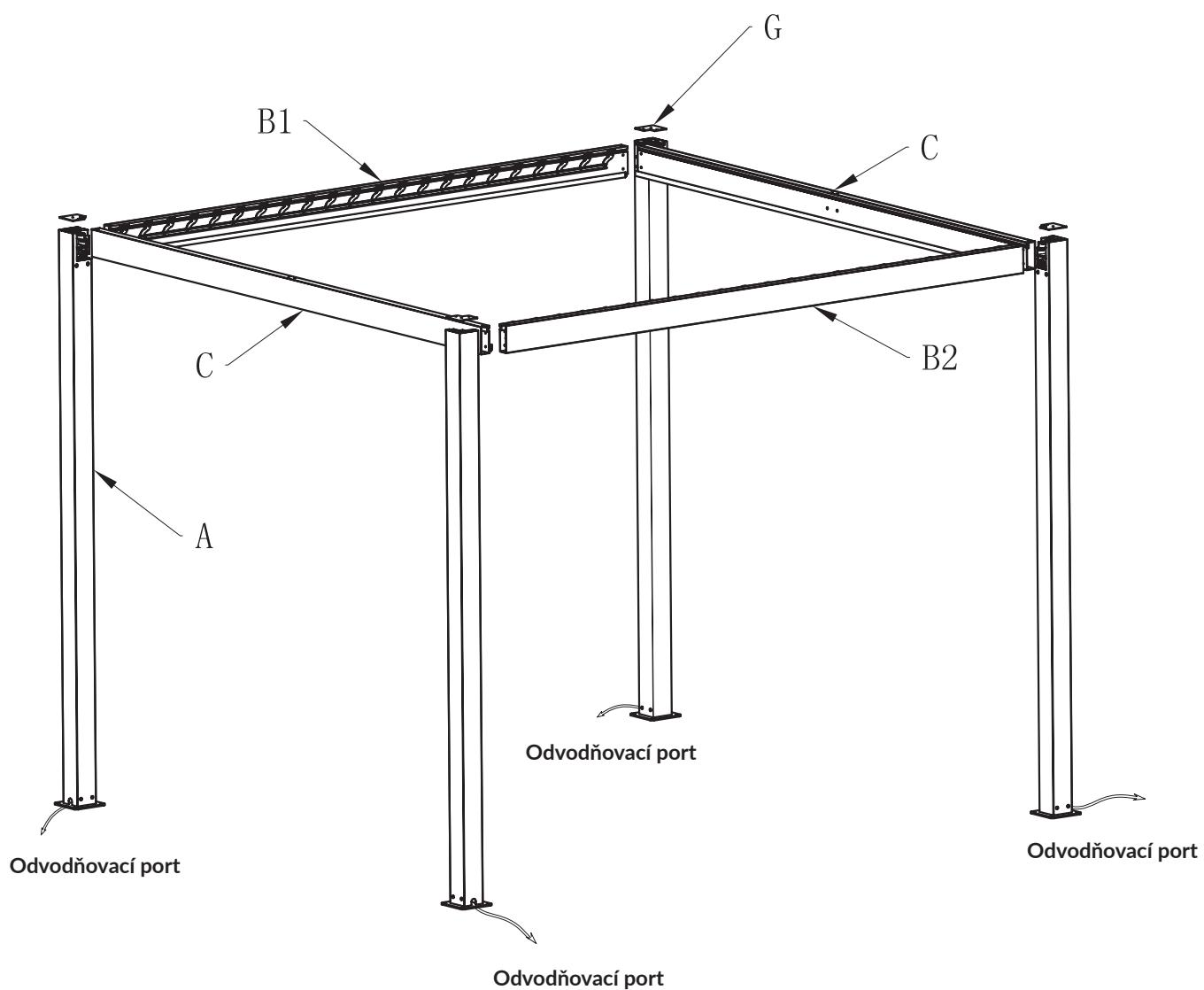
Ujistěte se, že jsou oba konce předního a zadního nosníku (C) správně umístěny na rohových konektorech na sloupu a že jsou dotaženy šrouby K1.
