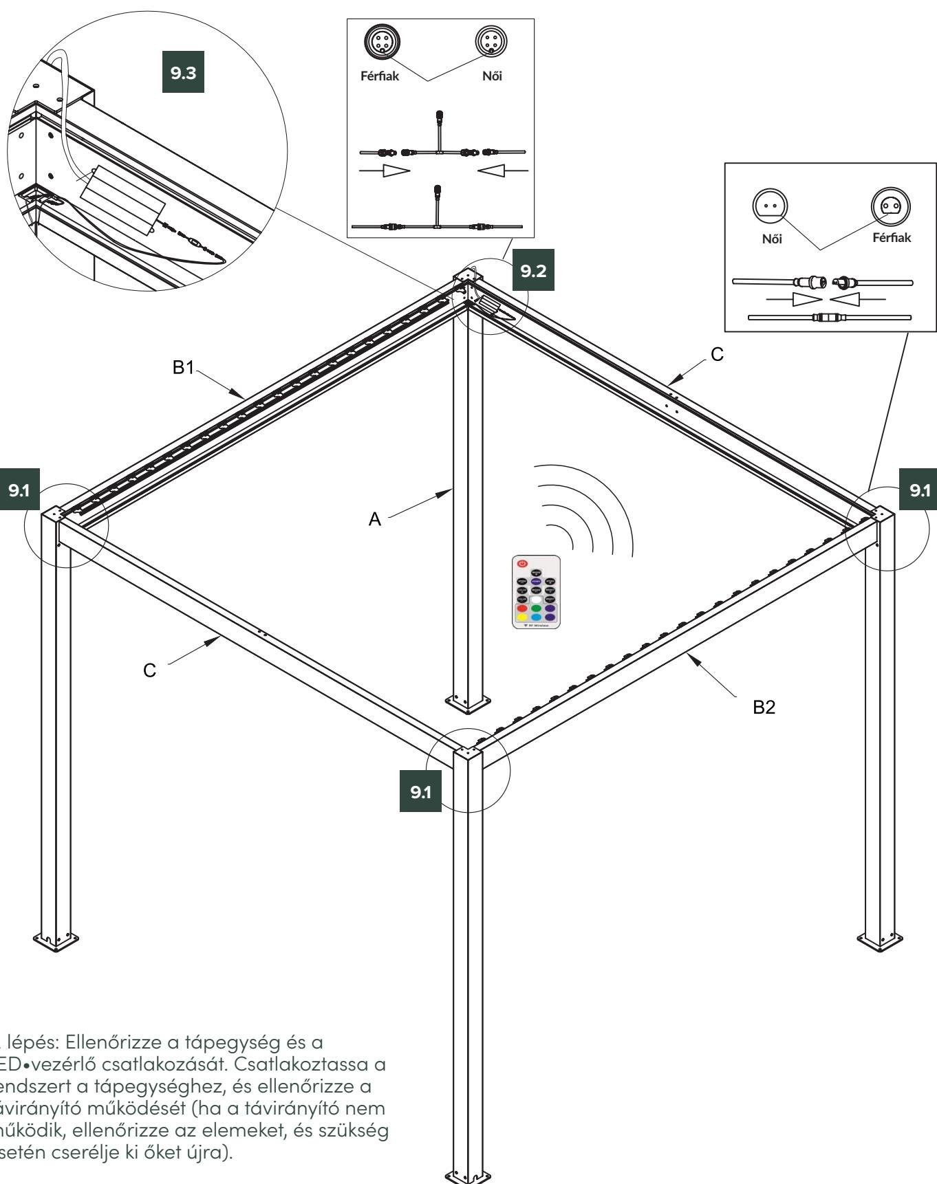
3. lépés: Ellenőrizze a tápegység és a LED•vezérlő csatlakozását. Csatlakoztassa a rendszert a tápegységhez, és ellenőrizze a távirányító működését (ha a távirányító nem működik, ellenőrizze az elemeket, és szükség esetén cserélje ki őket újra).
